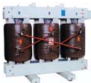
Transformador Trifásico a seco tipo RESIGLAS®, bobinas fabricadas pelo processo de encapsulamento em resina epóxi reforçado. Potências: 350 à 15000 kVA
