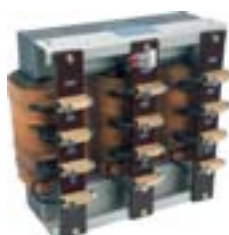
Autotransformador de Partida Trifásico a seco tipo ATPT, impregnado em verniz à vácuo. Potência: 10 a 500CV / 10 PH. Tensão: 220; 380 e 440V com Tap's 65/80%. Tempo de partida 15 seg. Equipados com Termostato na Bobina Central.
