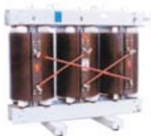
Transformador Trifásico a seco tipo RESIMOLD®, bobinas fabricadas pelo processo de encapsulamento em resina epóxi à vácuo. Potências: 5 à 300 kVA
